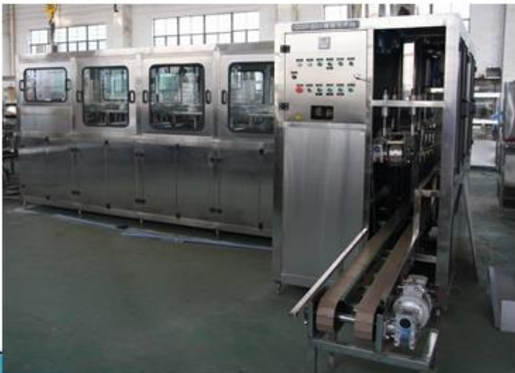
Linea Automática de Lavado, Llenado y Tapado de 5 Galones Capacidad: 300 botellas/hora
